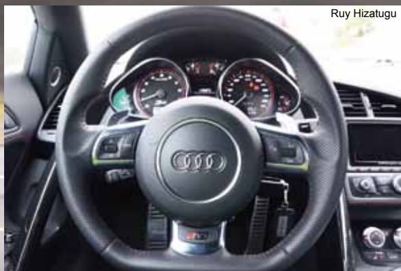
Volante multifuncional com borboletas para troca de marcha
